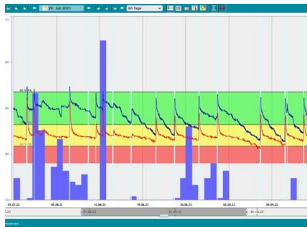
Abbildung 1: Grafik der Bodenfeuchtesensoren (blaue Linie Sensor 20 cm Tiefe, rote Linie Sensor 40 cm Tiefe, hellblaue Balken Bewässerungsgaben, dunkelblaue Balken natürlicher Niederschlag).
